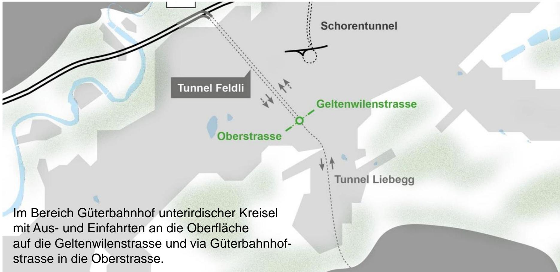
Im Bereich Güterbahnhof unterirdischer Kreisel mit Aus- und Einfahrten an die Oberfläche auf die Geltenwilenstrasse und via Güterbahnhofstrasse in die Oberstrasse.
